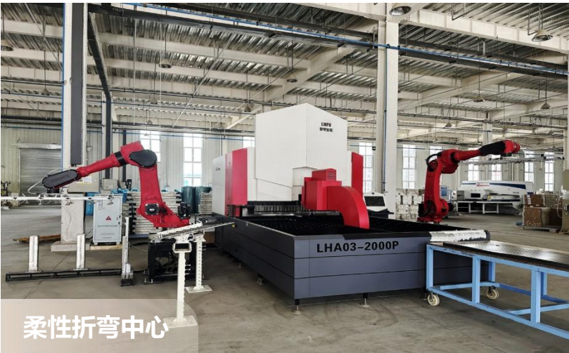
卷板送料→激光切割→柔性折弯→焊接→机器人收料
