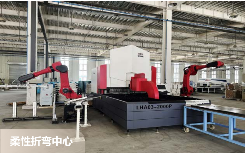
卷板送料→激光切割→柔性折弯→焊接→机器人收料
